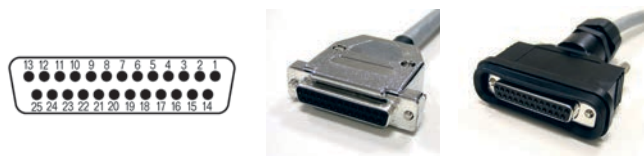
Schema di collegamento connettore SUB-D 25 SUB-D 25 Pin connector wiring scheme
